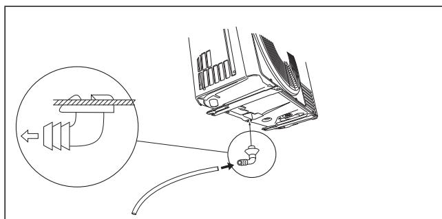
Когда блок работает в режиме нагрева в блоке образуется конденсат. Для того, чтобы его сливать устанавливается фитинг-дренаж и дренажный шланг для направления слива конденсата.
